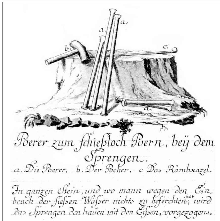
Abb. 1: Bohrgezähe (a: Bohrer, b: Schlegel, c: Räumkratze; D. KESSLER um 1800, Aquatinta; Sammlung A. WEISS, Wien).
