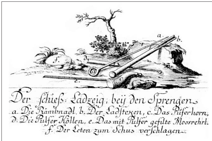
Abb. 3: „Schießzeug“ (a: Räumnadel, b: Ladestock, c: Pulverhorn, d: Pulverkelle, e: Zündröhrchen, f: Letten zum Abdämmen des Schusses; D. KESSLER um 1800, Aquatinta; Sammlung A. WEISS, Wien).
